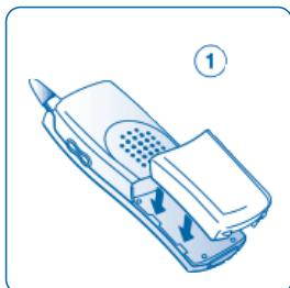
Positionner la batterie dans la glissière en suivant le repère indiqué sur l'étiquette
